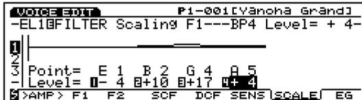
この例の場合、E1で-4のレベル、つまり現在のカットオフ周波数64より-4のオフセットで60、B2では+10のオフセットで74、G4では+17のオフセットで81、A5では+4のオフセットで68となり、これ以外の音程では、設定されたブレイクポイント間を直線で結んだ周波数となります。
