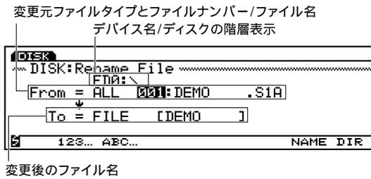
(必要に応じてデバイスを選びファイルタイプを選んで)ファイルナンバーでファイルを選択後、F7: NAMEキーを押してネーム画面を表示させ、変更するファイル名を入力します。ファイル名の付け方は、P.88をご参照ください。
