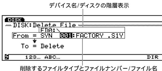
(必要に応じてデバイスを選び)ファイルナンバーで削除するファイルを選択後、ENTERキーを押します。「Delete File - Are You Sure?」という確認のメッセージが表示されます。YESキーを押して、デリートを実行します。NOキーを押すと、デリートをキャンセルします。
