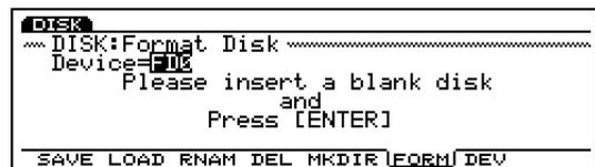
ディスクドライブに新しいディスクを挿入し(外部SCSI機器の場合は接続を確認し、新しいディスクを挿入し)、ENTERキーを押します。フロッピーディスクドライブのユーザランプが点灯し、フォーマットが始まります。フォーマット中は、Executing...(実行中)が表示されます。
