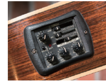
▲ピックアップはシステム41。通常のLシリーズには極力ボディに穴を開けないプッシュ/プッシュノブが採用されているが、彼の要望によりCPXシリーズで採用されていたタイプのプリアンプを内蔵。ピエゾをマグネティックピックアップに交換している。
