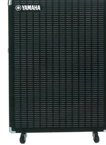
回転スピーカーが、キーボードのサウンドに独特のアリティを与える。YCシリーズ、またはSS-30と絶妙のマッチングを誇るアンプリファイア。出力：50Wr.m.s. 100Wpeak, 8Ω スピーカー：MAIN 38cm(JA3852) ×1, ROTARY(JA1701B) ×1 インプット：Ich 2IN(HIGH, LOW) コントロール：VOLUME, BASS, TREBLE, TREMOLO SPEED フットコントロール：SPEED(TREMOLO/CHORUS), VOICE(ON/OFF) 定格電圧・周波数：AC100V, 50/60Hz 定格消費電力：75W
