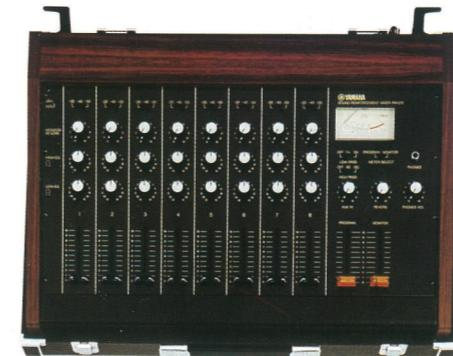
8チャンネル・イン、モノラルアウト。フォーニングジャックタイプ。マルチキーボードのミキシングダウンにも最適な機種です。入力端子：INPUT×8(PHONE JACK), AUX IN(PHONE JACK), FROM ECHO (PHONE JACK) 出力端子：PGM OUT×2(PHONE JACK), MONITOR OUT(PHONE JACK), AUX OUT×2(PHONE JACK), TO ECHO(PHONE JACK) 周波数特性：25Hz～15kHz ±0.5dB チャンネルコントロール：CHANNEL FADER, LOW-EQUALIZER, etc. マスター・コントロール：MASTER PROGRAM FADER, MASTER MONITOR FADER, AUX IN VOLUME, REVERB/ECHO VOLUME, PHONES VOLUME, HIGH-PASS FILTER SW(OFF/80/160Hz), LOW-PASS FILTER SW etc. 定格電圧・周波数：AC100V, 50/60Hz 定格消費電力：9W
