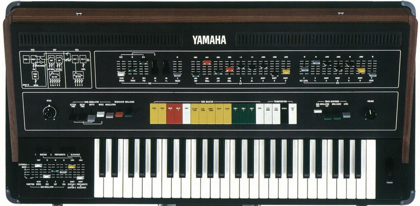
4音までのコード演奏ができる4音ポリフォニックシンセサイザー。49鍵ながら、トランスポジションにより7オクターブまでの演奏レンジをカバーします。VCO、VCF、VCAのシンセサイジング機能に加え、13の楽器音がワンタッチで選べるプリセットトーンシステムを採用。さらにタッチレスポンスLFOによるモジュレーション、リングモジュレーション、ポルタメント、グリッサンドなどの、エフェクトコントロールも豊富です。
