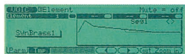
デジタルフィルターの動作状況はLCDに分かりやすくグラフィック表示されます。
