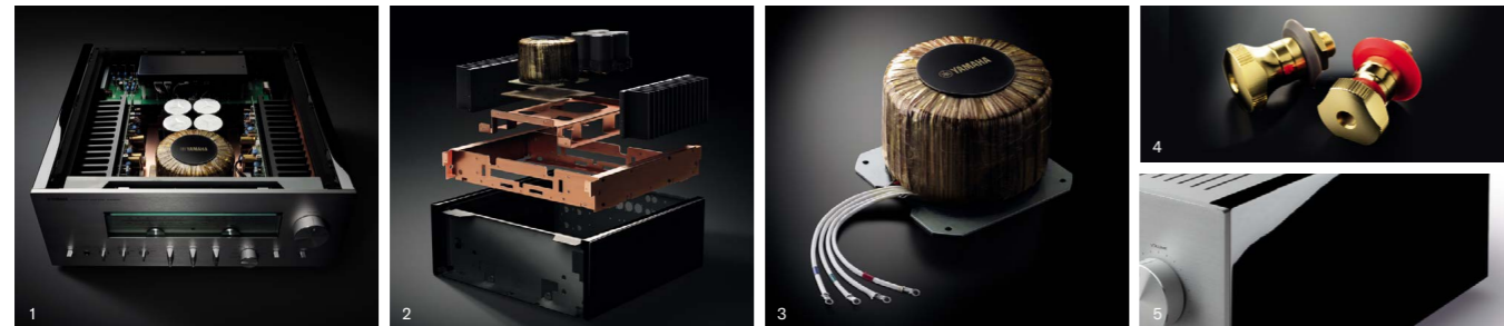
1: プリアンプ部をリアパネル側に配置。パワー部は、中央前方に巨大なトイダル電源トランス、左右に並列MOS-FET採用の出力段を配した完全独立・左右対称レイアウト 2: 銅メッキ銅板製の三次元ベースフレームを採用した高剛性・二重構造で振動の影響を全方位的に遮断するリジッド・ストリームライン・コンストラクション 3: 二次側巻線を直接取り出して給電ロス排除したカスタムメイドの大型トイダルトランス 4: 無垢の真鍮から削り出した大型スピーカー端子 5: ヤマハのグラウンドピアノと同じ塗装・研磨工程で仕上げたピアノブラックのサイドパネル
