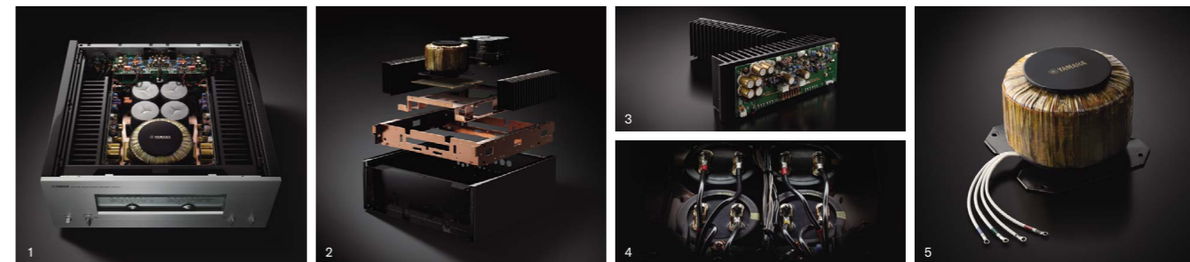
1: 中央前方に巨大なトイダル電源トランス、左右にパラレルMOS-FET採用の出力段を配置した完全左右対称レイアウト 2: 電源トランスやブロックメコンなど振動を伴う大型重量パーツを機構的に接地させるメカニカルグラウンド・コンセプトの導入により進化を遂げた独自のシャーシ構造=リジッドストリームラインド・コンストラクション 3: 放熱性と制振性を追求した大型ヒートシンクと回路基板を一体化したモノブロック構造 4: 大電流経路の主要配線をすべてネジ止め結線とするなどローインピーダンス設計を徹底 5: 二次側巻線を直接取り出して給電ロスを排除したカスタムメイド容量1200VAの大型トイダル電源トランス
