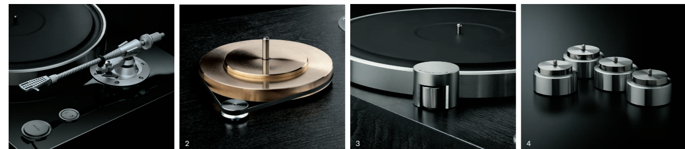
1：内部配線にPC-Triple C(ピーシートリプルシー)を採用したトーンアームとヤマハオリジナルのアルミ削り出しヘッドシェル 2：ターンテーブル回転を巨大な慣性重量で安定させる「GT思想」をさらに発展させ、インナーターンテーブルをベルトで駆動 3：±1.5%の範囲で回転数を微調整できるピッチコントロールレック 4：高度に調律されたコイルスプリングが不要共振を制御する特許機器株式会社による特製レック
