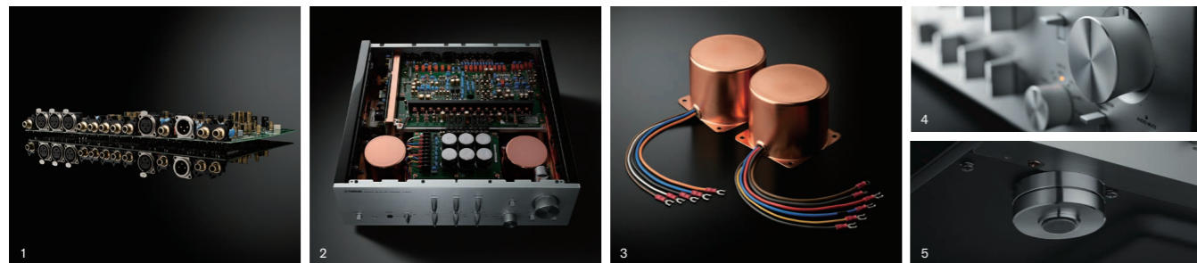
1: Lチャンネル用基板(上側)とRチャンネル用基板(下側)を鏡に映したような対称形に配置。プリントパターン面を向かい合わせてチャンネル間のグラウンドの距離を限りなくゼロに近づけるブックマッチ・コンストラクション 2: 本体前側の左右端に2基の電源トランスを据え、その間に6個のブロックケミコンを搭載したメインレギュレーター基板。最短距離かつ左右等長に給電されるようにその背後に配置されたメイン基板 3: 巻線からダイレクトに給電ワイヤーを引き出し、低インピーダンス化に貢献する真鍮ラグを採用した銅メッキケース封入のトイダル電源トランス 4: アルミ削り出しの真鍮高レバースイッチ。軸受部にボールベアリングを採用したボリュームノブ 5: スパイクを内蔵することで通常設置でもピンポイント支持効果を得ることができるC-5000/M-5000専用設計のレグ
