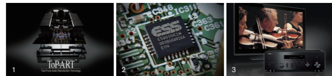
1:「ToP-ART」に基づき設計された左右対称の筐体 2: 32bit・2ch仕様のESS社製D/Aコンバーター「SABRE ES9010K2M」 3: テレビなどと接続できる192kHz/24bit対応の光/同軸デジタル音声入力端子を搭載
