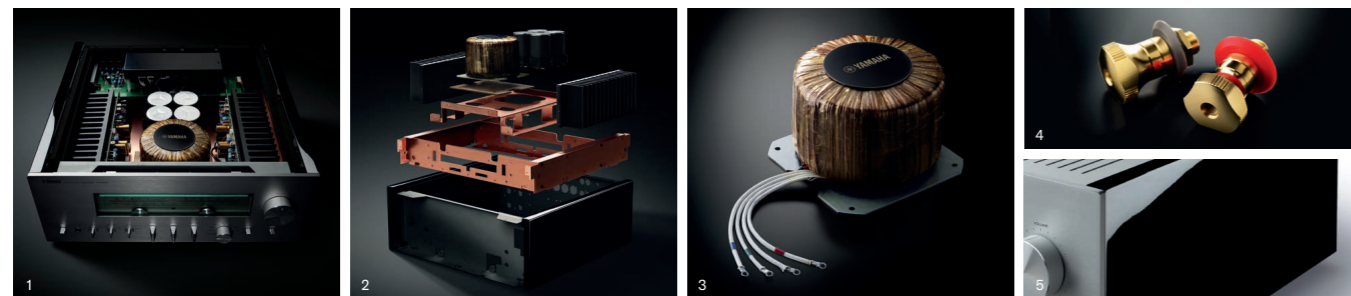
1：リアアンプ部をリアパネル側に配置。パワー部は、中央前方に巨大なトイダル電源トランス、左右に並列MOS-FET採用の出力段を配した完全独立・左右対称レイアウト 2：銅メッキ銅板製の三次元ベースフレームを採用した高剛性・二重構造で振動の影響を全方位的に遮断するリジッド・ストリームライン・コンストラクション 3：二次側巻線を直接取り出して給電ロス排除したカスタムメイドの大型トイダルトランス 4：無垢の真鍮から削り出した大型スピーカー端子 5：ヤマハのグラッドピアノと同じ塗装・研磨工程で仕上げたピアノブラックのサイドパネル
