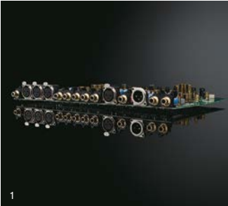
1：Lチャンネル用基板(上側)とRチャンネル用基板(下側)を鏡に映したような対称形に配置。プリントパターン面を向かい合わせてチャンネル間のグラウンドの距離を限りなくゼロに近づけるブックマッチ・コンストラクション
