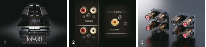
1：“ToP-ART”(Total Purity Audio Reproduction Technology)に基づき設計された左右対応の基板レイアウト&筐体設計 2：金メッキ加工を施し、音質の劣化を低減する入力端子群 3：バナナプラグ対応、金メッキ大型スピーカーターミナル
