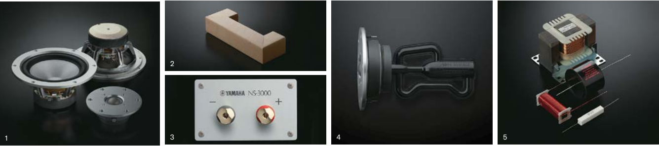
1：ダイヤフラムとサラウンドとを継ぎ目なく一体成型した100% ZYLON®16cm口径コーン型ウーファーと(左・上)と100% ZYLON®3cm口径ソフトドーム型ツイーター(右) 2：NS-3000の音響特性に合わせて専用設計された新形状の「アコースティックアブソーバー」 3：自然な聴き心地にこだわリシングルワイヤリングとした真鍮削り出しの高品位スピーカーターミナル 4：中央のメインチャンバーで発生した共鳴を長さが異なる左右2本の共鳴管で打ち消すR.S.チャンバー 5：ドイツ ムンドルフ社製のオーディオコンデンサー「MCap SUPREME EVO」や高音質アッテネーター「MResist SUPREME」Jなど、厳選した最高級パーツを使用したネットワーク回路
