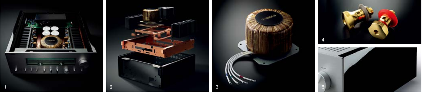
1：リアアンプ部をリアパネル側に配置。パワー部は、中央前方に巨大なトイダル電源トランス、左右にパレラルMOS-FET採用の出力段を配した完全独立・左右対称レイアウト 2：銅メッキ銅板製の三次元ベースフレームを採用した高剛性・二重構造で振動の影響を全方位的に遮断するリジッド・ストリームラインド・コンストラクション 3：二次側巻線を直接取り出して給電ロスを排除したカスタムメイドの大型トイダルトランス 4：無垢の真鍮から削り出した大型スピーカー端子 5：ヤマハのグラッドピアノと同じ塗装・研磨工程で仕上げたピアノブラックのサイドパネル
