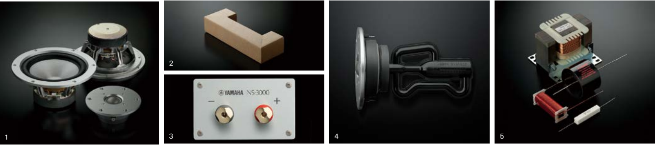
1：ダイヤフラムとサラウンドとを継ぎ目なく一体成型した100% ZYLON®16cm口径コーン型ウーファーと(左・上)と100% ZYLON®3cm口径ソフトドーム型ツイーター(右) 2：NS-3000の音響特性に合わせて専用設計された新形状の「アコースティックアブソーバー」 3：自然な聴き心地にこだわシングルワイヤリングとした真鍮削り出しの高品位スピーカーターミナル 4：中央のメインチャンバーで発生した共鳴を長さが異なる左右2本の共鳴管で打ち消すR.S.チャンバー 5：ドイツ ムンドルフ社製のオーディオコンデンサー「MCap SUPREME EVO」や高音質アッテネーター「MResist SUPREME」Jなど、厳選した最高級パーツを使用したネットワーク回路
