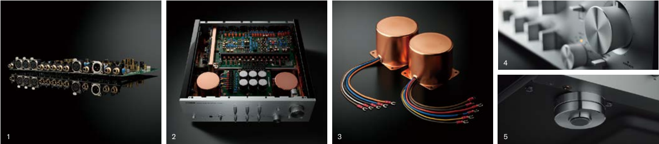
1：Lチャンネル用基板(上側)とRチャンネル用基板(下側)を鏡に映したような対称形に配置。プリントパターン面を向かい合わせてチャンネル間のグラウンドの距離を限りなくゼロに近づけるブックマッチ・コンストラクション 2：本体前側の左右端に2基の電源トランスを据え、その間に6個のブロックケミコンを搭載したメインレギュレーター基板。最短距離かつ左右等長に給電されるようにその背後に配置されたメイン基板 3：巻線からダイレクトに給電ワイヤーを引き出し、低インピーダンス化に貢献する真鍮ラグを採用した銅メッキケース封入のトロイダル電源トランス 4：アルミ削り出しの質感高いレバー・スイッチ、軸受部にボールベアリングを採用したボリュームノブ 5：スパイクを内蔵することで通常設置でもピンポイント支持効果を得ることができるC-5000/M-5000専用設計のレグ
