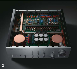
1：Lチャンネル用基板(上側)とRチャンネル用基板(下側)を鏡に映したような対称形に配置。プリントパターン面を向かい合わせてチャンネル間のグラウンドの距離を限りなくゼロに近づけるブックマッチ・コンストラクション 2：本体前側の左右端に2基の電源トランスを据え、その間に6個のブロックケミコンを搭載したメインレギュレーター基板。最短距離かつ左右等長に給電されるようにその背後に配置されたメイン基板 3：巻線からダイレクトに給電ワイヤーを引き出し、低インピーダンス化に貢献する真鍮ラグを採用した銅メッキケース封入のトロイダル電源トランス 4：アルミ削り出しの真鍮高いレバー・スイッチ、軸受部にボールベアリングを採用したボリュームノブ 5：スパイクを内蔵することで通常設置でもピンポイント支持効果を得ることができるC-5000/M-5000専用設計のレグ
