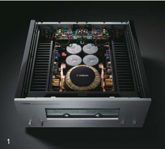
1：中央前方に巨大なトロイダル電源トランス、左右にパラレルMOS-FET採用の出力段を配置した完全左右対称レイアウト 2：電源トランスやブロックケミコンなど振動を伴う大型重量パーツを機構的に接地させるメカニカルグラウンド・コンセプトの導入により進化を遂げた独創的シャーシ構造＝リジッドストリームラインド・コンストラクション 3：放熱性と制振性を追求した大型ヒートシンクと回路基板を一体化したモノブロック構造 4：大電流経路の主要配線をすべてネジ止め結線とするなどローインピーダンス設計を徹底 5：二次側巻線を直接取り出して給電口を排除したカスタムメイド 容量1200VAの大型トロイダル電源トランス
