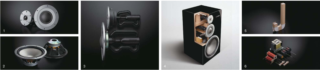
1：ダイヤフラムとサラウンドとを継ぎ目なく一体化成型した世界初の100%PBO繊維ザイロン®8cm口径ソフトドーム型ミッドレンジ(右)と100%PBO繊維ザイロン®3cm口径ソフトドーム型ツイーター(左) 2：750Hzのローパス周波数で最適なバフォーマンスを発揮するワイドレンジ設計の100% PBO繊維ザイロン®30cm口径コンケーブコーン型ウーファー 3：中央のメインチャンバーで発生した共鳴を長さが異なる左右2本の共鳴管で打ち消すR.S.チャンバー 4：総三方留め構造をはじめとするヤマハの伝統的工法によって強固に組み上げたエンクロージャー 5：エンクロージャー内に設置された専用設計のアコースティックアブソーバー 6：ドイツ ムンドルフ社製のオーディオコンデンサー「MCap SUPREME EVO」や高音質アッテネーター「MResist SUPREME」、単体質量1.6kgに達するウーファー用コイルなど、厳選した最高級パーツを使用したネットワーク回路
