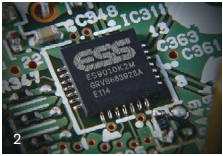
1：「ToP-ART」に基づき設計された左右対称の筐体 2：32bit・2ch仕様のESS社製D/Aコンバーター「SABRE ES9010K2M」 3：テレビなどとも接続できる192kHz/24bit対応の光/同軸デジタル音声入力端子を搭載
