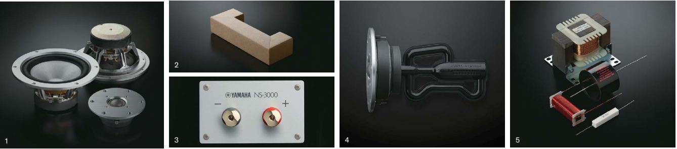
1：ダイヤフラムとサラウンドとを継ぎ目なく一体化成型した100%PBO繊維ザイロン®16cm口径コーン型ウーファーと(左・上)と100%PBO繊維ザイロン®3cm口径ソフトドーム型ツイーター(右) 2：NS-3000の音響特性に合わせて専用設計された新形状の「アコースティックアブソーバー」 3：自然な聴き心地にこだわりシングルワイヤリングとした真鍮削り出しの高品位スピーカーターミナル 4：中央のメインチャンバーで発生した共鳴を長さが異なる左右2本の共鳴管で打ち消すR.S.チャンバー 5：ドイツ ムンドルフ社製のオーディオコンデンサー「MCap SUPREME EVO」や高音質アッテネーター「MResist SUPREME」など、厳選した最高級パーツを使用したネットワーク回路
