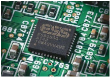
1：「ToP-ART」に基づき設計された左右対称の筐体 2：PCM 384kHz/32bit、DSD 11.2MHzネイティブ再生を可能にする高性能D/Aコンバーター「ES9080Q」 3：独自の振動吸収構造を採用したアンテナ共振シールド
