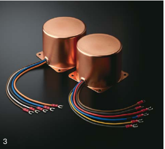
1：Lチャンネル用基板(上側)とRチャンネル用基板(下側)を鏡に映したような対称形に配置。プリントパターン面を向かい合わせてチャンネル間のグラウンドの距離を限りなくゼロに近づけるブックマッチ・コンストラクション 2：本体前側の左右端に2基の電源トランスを据え、その間に6個のブロックケミコンを搭載したメインレギュレーター基板。最短距離かつ左右等長に給電されるようにその背後に配置されたメイン基板 3：巻線からダイレクトに給電ワイヤーを引き出し、低インピーダンス化に貢献する真鍮ラグを採用した銅メッキケース封入のトロイダル電源トランス 4：アルミ削り出しの真鍮高いレバー・スイッチ、軸受部にボールベアリングを採用したボリュームノブ 5：スパイクを内蔵することで通常設置でもピンポイント支持効果を得ることができるC-5000/M-5000専用設計のレグ
