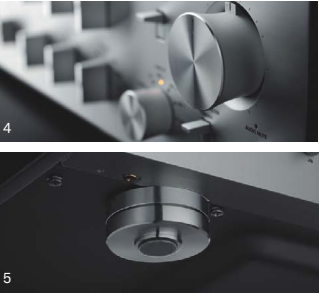
1：Lチャンネル用基板(上側)とRチャンネル用基板(下側)を鏡に映したような対称形に配置。プリントパターン面を向かい合わせてチャンネル間のグラウンドの距離を限りなくゼロに近づけるブックマッチ・コンストラクション 2：本体前側の左右端に2基の電源トランスを据え、その間に6個のブロックケミコンを搭載したメインレギュレーター基板。最短距離かつ左右等長に給電されるようにその背後に配置されたメイン基板 3：巻線からダイレクトに給電ワイヤーを引き出し、低インピーダンス化に貢献する真鍮ラグを採用した銅メッキケース封入のトロイダル電源トランス 4：アルミ削り出しの真鍮高いレバー・スイッチ、軸受部にボールベアリングを採用したボリュームノブ 5：スパイクを内蔵することで通常設置でもピンポイント支持効果を得ることができるC-5000/M-5000専用設計のレグ
