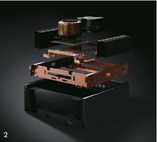
1：中央前方に巨大なトロイダル電源トランス、左右にパラレルMOS-FET採用の出力段を配置した完全左右対称レイアウト 2：電源トランスやブロックケミコンなど振動を伴う大型重量パーツを機構的に接地させるメカニカルグラウンド・コンセプトの導入により進化を遂げた独創的シャーシ構造＝リジッドストリームラインド・コンストラクション 3：放熱性と制振性を追求した大型ヒートシンクと回路基板を一体化したモノブロック構造 4：大電流経路の主要配線をすべてネジ止め結線とするなどローインピーダンス設計を徹底 5：二次側巻線を直接取り出して給電口を排除したカスタムメイド 容量1200VAの大型トロイダル電源トランス
