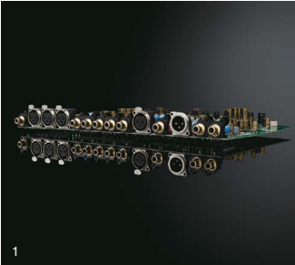
1：Lチャンネル用基板(上側)とRチャンネル用基板(下側)を鏡に映したような対称形に配置。プリントパターン面を向かい合わせてチャンネル間のグラウンドの距離を限りなくゼロに近づけるブックマッチ・コンストラクション 2：本体前側の左右端に2基の電源トランスを据え、その間に6個のブロックケミコンを搭載したメインレギュレーター基板。最短距離かつ左右等長に給電されるようにその背後に配置されたメイン基板 3：巻線からダイレクトに給電ワイヤーを引き出し、低インピーダンス化に貢献する真鍮ラグを採用した銅メッキケース封入のトロイダル電源トランス 4：アルミ削り出しの真鍮高いレバー・スイッチ、軸受部にボールベアリングを採用したボリュームノブ 5：スパイクを内蔵することで通常設置でもピンポイント支持効果を得ることができるC-5000/M-5000専用設計のレグ
