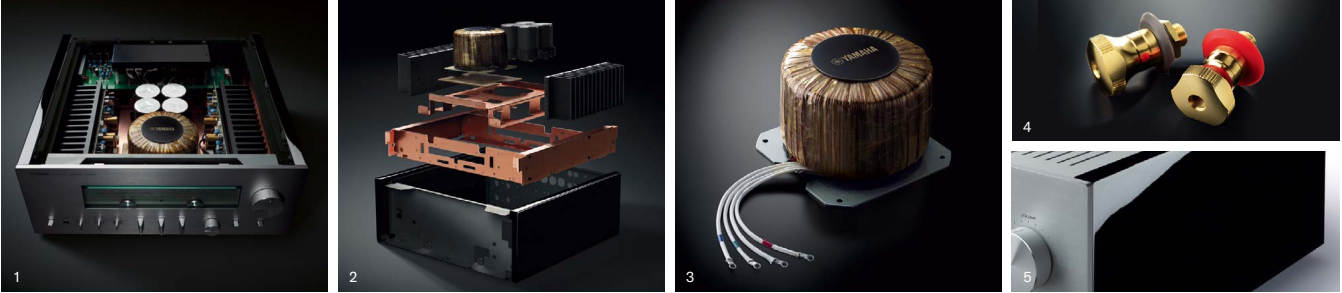
1：リアアンプ部をリアパネル側に配置。パワー部は、中央前方に巨大なトロイダル電源トランス、左右にパレラルMOS-FET採用の出力段を配した完全独立・左右対称レイアウト 2：銅メッキ銅板製の三次元ベースフレームを採用した高剛性・二重構造で振動の影響を全方位的に遮断するリジッド・ストリームラインド・コンストラクション 3：二次側巻線を直接取り出して給電ロスを除いたカスタムメイドの大型トロイダルトランス 4：無垢の真鍮から削り出した大型スピーカー端子 5：ヤマハのグラウンドピアノと同じ塗装・研磨工程で仕上げたピアノブラックのサイドパネル
