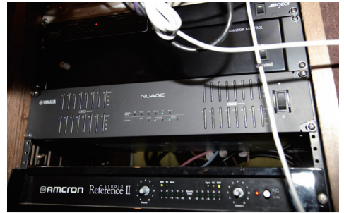
コントロール・ルームに用意された「Nuage I/O 16A」。アナログ16ch入出力のモデル
