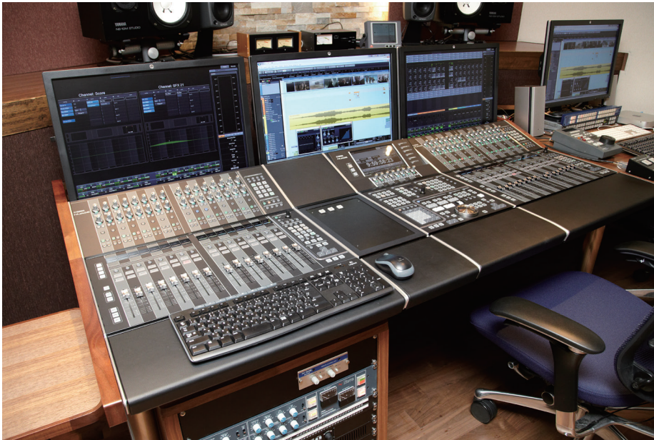
「株式会社 IMAGICA 麻布十番スタジオ」に導入された「Nuage」システム。32 フェーダー仕様で、向かって左から「Nuage Fader」、「Nuage Workspace (SMALL)」(純正のブランク・ユニット)、「Nuage Master」、「Nuage Fader」というコンポーネント構成になっている。各コンポーネントが置かれたデスクは、特注品とのこと。ホスト・コンピューターは Windows プラットホームの「Hewlett-Packard HP Z820 Workstation」で(マシン・ルームに設置)、同じ「Hewlett-Packard」社製の24インチ・モニター・ディスプレイ「HP Z24i」が3面設置されている
