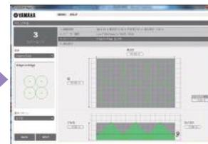
スピーカーの配置パターンを選択します。プロジェクトに必要なスピーカーの台数を、見積もることができます。
