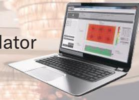
Commercial Installation Solutions Speaker Calculator (CISSCA:シスカ) は、スピーカーを設置する部屋の大きさや用途、スピーカーの種類や配置パターンなどの条件を入力することで、その条件に最適なスピーカーの台数を素早く見積もることができ、見積もり結果の実効音圧値を確認できるカリキュレーションソフトウェアです。
