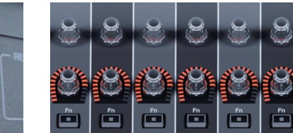
RIVAGE PM10、RIVAGE PM7は、各チャンネルに2つのエンコーダーを装備しています。5つの機能を割り当てられるチャンネルストリップエンコーダーと、隣接するタッチパネル上に対応したパラメーターを制御するスクーリングエンコーダーです。物理操作子であるエンコーダーは、リアルタイムでのコントロール時に圧倒的な利便性を提供します。各チャンネルで2つのエンコーダーを使用できるRIVAGE PM10とRIVAGE PM7は極めて優れた操作性を有しています。
