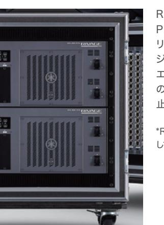
RIVAGE PM10、RIVAGE PM5、RIVAGE PM3はフェイルセーフのためのDSPミラーリングに対応しています。2台の同じDSPエンジンを使用することで、万が一メインのDSPエンジンにトラブルが発生した場合でも、サブのDSPエンジンに切り替えることでショーを止めずに続行することができます。
