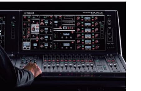
コントロールサーフェスのトップパネル右側には、ヤマハ定番のSelected Channelセクションをフル仕様でレイアウト。SELキー選択したチャンネルの主要なパラメーターをダイレクトに操作できます。左側にはタッチオペレーションに対応した2つの大型液晶タッチパネルを搭載<sup>\*</sup>し、手前へ流れるように繋がるフェーダー面とのコンピネーションにより、定評のあるCentralogicと同様の操作性を実現。これら2つの特長に加え、エンコーダー周りの視認性を向上させるなど、快適かつ確実なオペレーションのためのディテールにも気を配りました。
