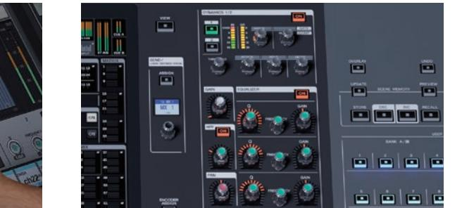
タッチ感度にも優れた静電容量式タッチパネルの15インチディスプレイを搭載。基本的なタッチ操作だけでなくピンchingアウトやスワイプなどのジェスチャーも使用できるため、操作効率が大幅に向上します。また、ディスプレイはおなじみのヤマハSelected Channelセクションと連動し、基本的な物理操作もコンパクトにまとっています。重要なコントロール項目や情報がわかりやすく整理されて表示されるため、エンジニアは状況をすばやく把握しつつ、直感的な操作が可能です。
