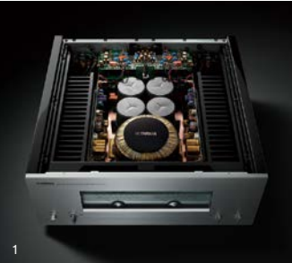
1：中央前方に巨大なトロイダル電源トランス、左右にパラレルMOS-FET採用の出力段を配置した完全左右対称レイアウト
