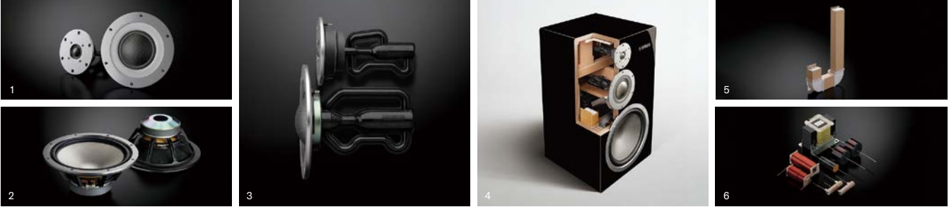
1：ダイヤフラムとサラウンドとを継ぎ目なく一体成型した世界初の100% ZYLON®8cm口径ソフトドーム型ミッドレンジ(右)と100% ZYLON®3cm口径ソフトドーム型ツイーター(左) 2：750Hzのローパス周波数で最適なパフォーマンスを発揮するワイドレンジ設計の100% ZYLON®30cm口径コンケーブコーン型ウーファー 3：中央のメインチャンバーで発生した共鳴を長さが異なる左右2本の共鳴管で打ち消すR.S.チャンバー 4：総三方留め構造をはじめとするヤマハの伝統的工法によって強固に組み上げたエンクロージャー 5：エンクロージャー内に設置された専用設計のアコースティックアブソーバー 6：ドイツ ムンドルフ社製のオーディオコンデンサー「MCap SUPREME EVO」や高音質アッテネーター「MResist SUPREME」J、単体質量1.6kgに達するウーファー用コイルなど、厳選した最高級パーツを使用したネットワーク回路
