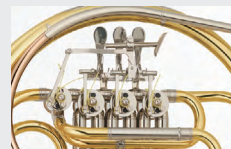
ストリングアクション 押し始め、戻り始めがなめらかで、レバーの高さを無段階で調整できる。
