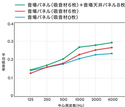
音場パネル内の吸音材0枚と6枚、さらに、吸音材6枚プラス別売の音場天井パネルを8枚使用した場合の平均吸音率を表したグラフです。グラフの上限と下限の間で響きの調整が可能です。
