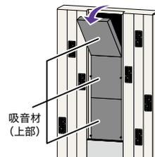
内部の吸音材の枚数を調節することで、室内の響きをイメージに合わせて調整できます。
