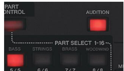
ボタン一つで最適なデモフレーズによる音色チェックが可能なオーディション機能を搭載
