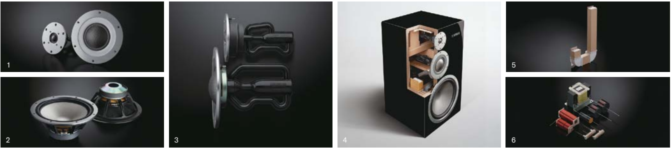
1：ダイヤフラムとサラウンドとを継ぎ目なく一体成型した世界初の100% ZYLON®8cm口径ソフトドーム型ミッドレンジ(右)と100% ZYLON®3cm口径ソフトドーム型ツイーター(左) 2：750Hzのローパス周波数で最適なパフォーマンスを発揮するワイドレンジ設計の100% ZYLON®30cm口径コンケープコーン型ウーファー 3：中央のメインチャンバーで発生した共鳴を長さが異なる左右2本の共鳴管で打ち消すR.S.チャンバー 4：総三方留め構造をはじめとするヤマハの伝統的工法によって強固に組み上げたエンクロージャー 5：エンクロージャー内に設置された専用設計のアコースティックアブソーバー 6：ドイツ ムンドルフ社製のオーディオコンデンサー「MCap SUPREME EVO」や高音質アッテネーター「MResist SUPREME」J、単体質量1.6kgに達するウーファー用コイルなど、厳選した最高級パーツを使用したネットワーク回路
