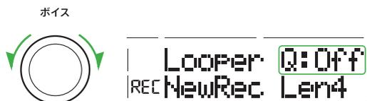
クオンタイズとは、録音タイミングの「ずれ」を補正する機能です。正確に弾いたつもりでも、タイミングが微妙に遅れたり早かったりします。録音する演奏の最も細かい音符に設定すると、正確に補正されます。逆に演奏したままで録音したい場合は、「Off」に設定します。
