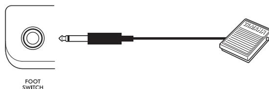
初期設定ではサステイン機能が割り当てられています。ピアノのダンパーペダルと同様に、フットスイッチを踏んでいる間、鍵盤から指を離しても音を響かせることができます。サステイン以外の機能を使う場合は、機能設定画面(107ページ 機能番号054)で設定します。
