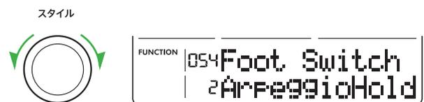
フットスイッチの機能を通常のサステインペダルに戻したいときは、「Sustain」を選びます。アルペジオホールドとサステインを同時に有効にしたいときは、「Sus+ArpHold」を選びます。
