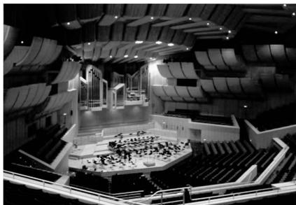
「その空間が持つ特有の音の響き」を音場と呼んでいます。コンサートホールなどで、私達は、楽器の音や歌手の声が直接聴こえてくる「直接音」の他に、床や壁・天井などに一回反射してから聴こえてくる「初期反射音」、さらに何回も反射を繰り返しながら次第に減衰してゆく「後部残響音」を聴くことになります。
