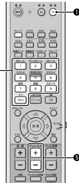
TV/AV/YSPスイッチをTV/AV側にスライドさせてから、チューナーキーを押して入力をチューナーに切り替えます。
