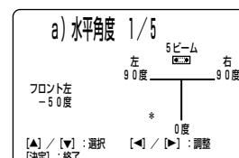
左方向に調節すると音が出力される方向は左方向へ移動し、右方向に調節すると右方向へ移動します。
