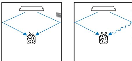
このような場合、カーテンが開いている状態で「ビーム調整+音質調整」を行い、測定結果を「メモリー1」に保存します。次にカーテンが閉じている状態で「音質調整」を行い、測定結果を「メモリー2」に保存します。このようにすると、ご使用の際にリスニングルームの状況に応じて設定を切り替えることができ、最適な環境でサラウンドサウンドをお楽しみいただけます。
