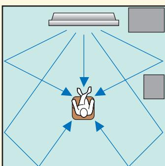
本機をリスニングルームのコーナーに設置した場合のイメージ図です。隣接する壁との角度が40°～50°の間におさまるように設置してください。
