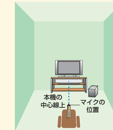
マイクは本機から1.8m以上離し、本機の中心線上に設置してください。また、本機から上下1m以内の位置に設置してください。
