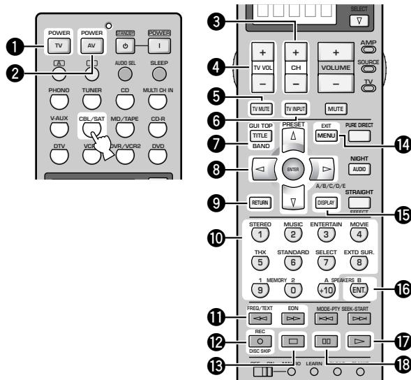
ライブラリー/リモコンコードを設定してから、入力選択キーのCBL/SATキーを押すと、衛星放送のチューナーを操作できます。
