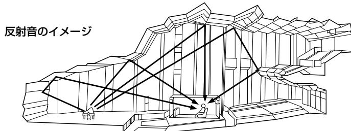
直接音、初期反射音、後部残響音がひとつになることで、リスナーは演奏会場や劇場をイメージすることができます。デジタル音場プロセッサーはこの反射音、残響音を再現することで、音場を作り出します。
