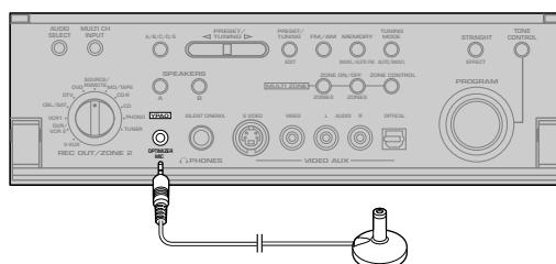
オプティマイザーマイクは実際に視聴する位置(リスニングポジション)に、耳と同じ高さで設置します。耳と同じ高さに設置する場合は、水平な台にのせるか、三脚を使います。
