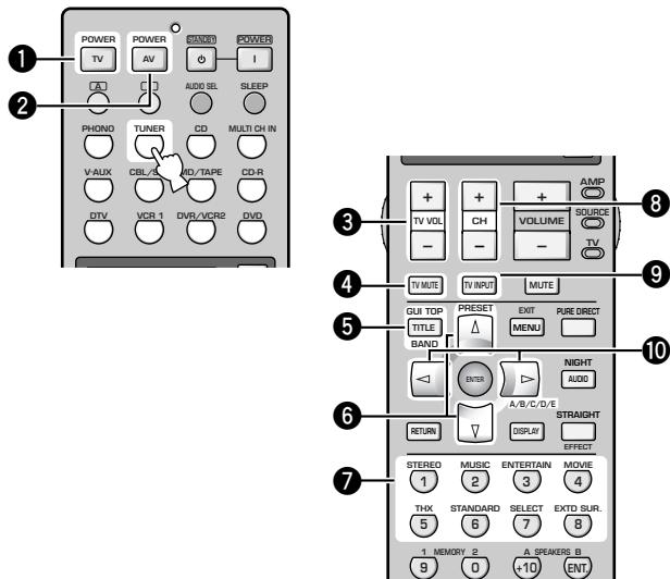
入力選択キーのTUNERキーを押すとチューナーを操作できます。
