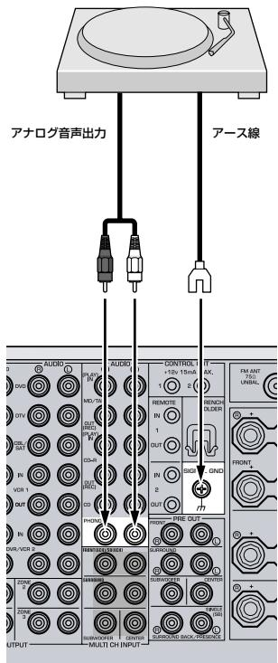
低出力型MCカートリッジ付のレコードプレーヤーを接続するときは、昇圧トランジスタまたはMCヘッドアンプを使って接続します。
