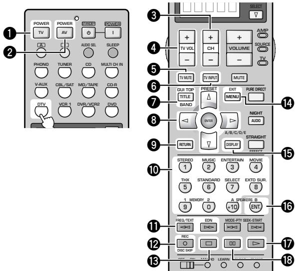
リモコンコードを設定してから、入力選択キーのDTVキーを押すと、テレビを操作できます。
