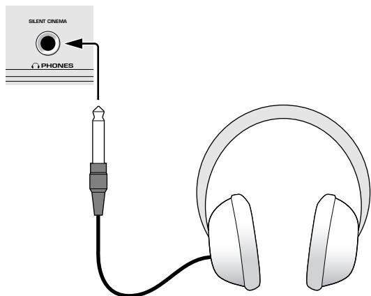
「サイレントシネマ」モードでは、マルチスピーカーによる音場プログラムの効果を、ヘッドホンで擬似的に再現します。
