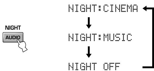
ナイトリスニングモードで再生している間は、フロントパネルディスプレイのNIGHTインジケーターが点灯します。
