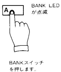
BANKスイッチを押した後、前頁の表より、プログラムセレクトスイッチの4を押し、次に12を押します。
