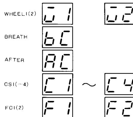
系列Bプログラムセレクトスイッチ1~16(0~F)により、コントローラーコード(パネル右側に印刷してあるコントローラーコードプリセットテーブルより選ぶ。)を入力すると、ディスプレイ表示が入力したコードに変わり、設定が完了します。
