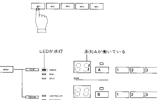
ボイスNo.の選択は、先程と同じようにBANKスイッチとプログラムセレクトスイッチで行なえます。
