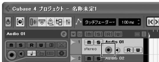
[REC READY] スイッチを使って複数トラックの Record Enable ボタンをオンにしたい場合は、Cubase 側で以下の設定を行なってください。
