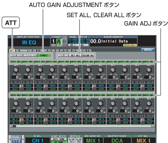
2. 画面上部の AUTO GAIN ADJUSTMENT ボタンをクリックして、ENABLE(有効)に設定します。ENABLE に設定すると、自動調整機能が有効になります。
