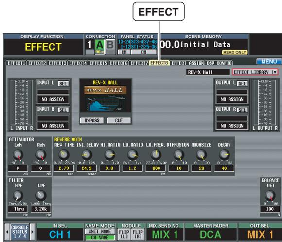
VCM (Virtual Circuitry Modeling) 技術によりアナログ回路の特性をモデリングしたコンプレッサーや EQ、オープンリールテープによって生み出されるテープコンプレッションをエミュレートした OpenDeck、新規アルゴリズムで豊かな残響音となめらかな減衰を実現するリバーブ REV-X が搭載されています。それぞれの VCM エフェクトについて詳しくは、巻末の 18 ページをご参照ください。
