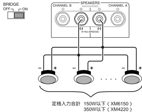
**注意:** 必ず70Vライン出力と一致した入力電圧のスピーカーをご使用ください。
