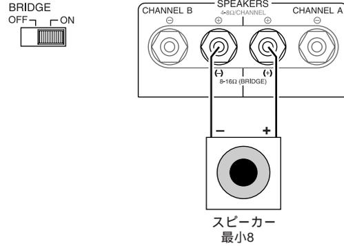
BRIDGEモードでは、70Vのライン出力に対応した複数のハイインピーダンススピーカーを並列接続できます。接続できるスピーカーの本数は、それぞれのスピーカーの定格入力によって決まり、チャンネルごとに定格入力の合計値が150W( XM6150 )、350W( XM4220 )まで接続できます。
