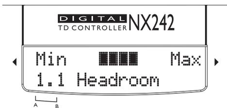
プロセッサの全体ゲインは変化させずに、A/D コンバータ入力前のヘッドルームを 3 dB ステップで 8 段階に調整できます。工場デフォルトでは、最大のヘッドルーム値(すなわち、ノイズが最大)に設定されています。オーディオレベルが低いアプリケーションでプロセッサのノイズが大き過ぎると感じられる場合、ヘッドルームを調整できます。
