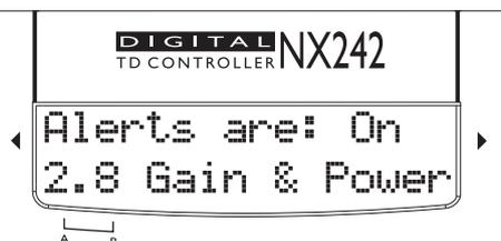
エンコーダーを回し、メニュー2.8の2番目の画面である警告を非表示にするメニューを表示させます。ENTER (◀▶) ボタンを押し、警告 (LED の点滅) を ON または OFF に設定します。非表示に設定すると、ゲイン設定が正しくない場合でも LED は点滅しません。このパラメータは、NX242 がデフォルト画面に戻るたびに保存され、またメニュー1.5 で設定内容を保存する時にも保存されます。
