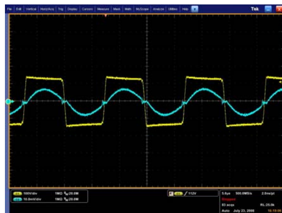
[図12] ヤマハフル共振型電源。波形はスムーズで、スイッチングノイズは非常に少ない。黄色が電圧、青が電流。
