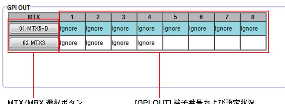
プリセットのリコールと同時に出力される GPI OUT の設定を行ないます。GPI OUT の出力によって、本体の [GPI OUT] 端子に接続された機器をコントロールします。
