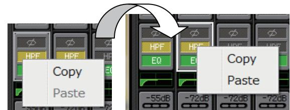
**NOTE** コピーできるコンポーネントは「GAIN/HPF/EQ」「GATE/COMP」「AGC」「GAIN/EQ」「COMP/AGC」「DELAY/ROOM EQ」「SPEAKER PROCESSOR」です。ただし、「GAIN/HPF/EQ」のうち「 $\phi$ 」がコピー対象外となります。
