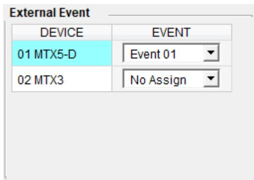
プリセットのリコールと同時に出力されるイベントの設定を行ないます。本体の NETWORK 端子や Dante [PRIMARY]/[SECONDARY] 端子 (リダンダントの時は通信をしている回線) からイベントを出力します。
