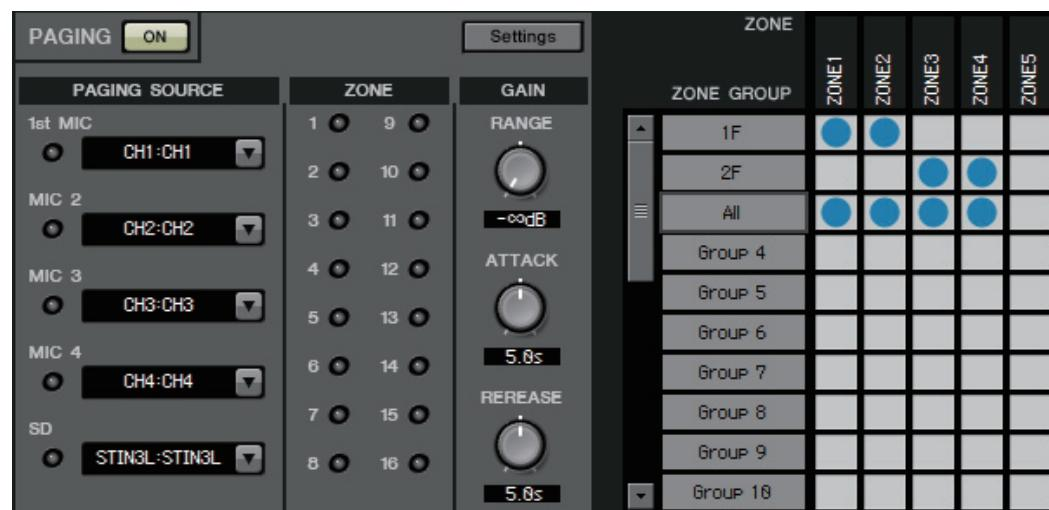
7. 「ZONE」画面の「PAGING」画面の[Settings]ボタンをクリックして、[Function Assign]タブでPGM1/PGX1のゾーン / メッセージ選択ボタンに機能を割り振る。
