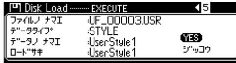
**!** フロッピーディスクのデータを PSR-740/640本体にロードすることによって、本体に記録されていたデータはフロッピーディスクのデータに書き替えられます。大切なデータはロードする前にフロッピーディスクにセーブしておきましょう。
