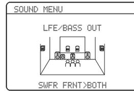
LFE 信号や低音域成分を出力するスピーカーを設定します。LFE 信号とは、ドルビーデジタルやDTS、AACの音声に含まれる120Hz以下の低域効果音のことです。
