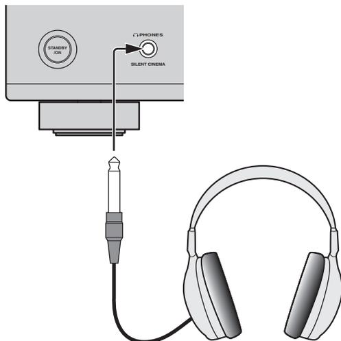
サイレントシネマ™モードでは、マルチスピーカーによる音場プログラムの効果を、ヘッドホンで擬似的に再現します。サイレントシネマ™モードで再生しているあいだは、フロントパネルディスプレイの SILENT CINEMA インジケーターが点灯します。
