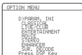
設定が変更されている音場プログラムは、プログラム名の前に「\*」(アスタリスク)が表示されます。リモコンの音場プログラムキーで、パラメーターを初期設定に戻したい音場プログラムを選んでください。
