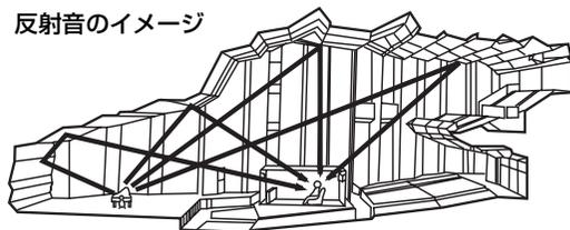
直接音、初期反射音、後部残響音が1つになることで、リスナーは演奏会場や劇場をイメージすることができます。デジタル音場プロセッサーはこの反射音、残響音を再現することで、音場を作り出します。
