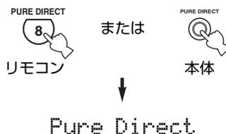
ピュアダイレクトモードで再生している間は、本体のPURE DIRECTキーが青色で点灯し、フロントパネルディスプレイは消灯します。
