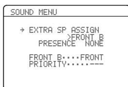
リアパネルのEXTRA SP端子に接続したスピーカーの用途を設定します。
