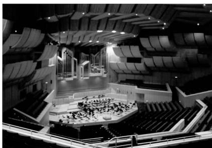
「その空間が持つ特有の音の響き」を音場と呼んでいます。コンサートホールなどで私達は、楽器の音や歌手の声が直接聴こえてくる「直接音」のほかに、床や壁、天井などに1回反射してから聴こえてくる「初期反射音」、さらに何回も反射を繰り返しながら次第に減衰してゆく「後部残響音」を聴くことになります。建物内部の形状や広さ、それに内装材料の種類等によって、初期反射音や残響音の構成が異なり、そのホール特有の響きが生まれます。それが「音場」です。
