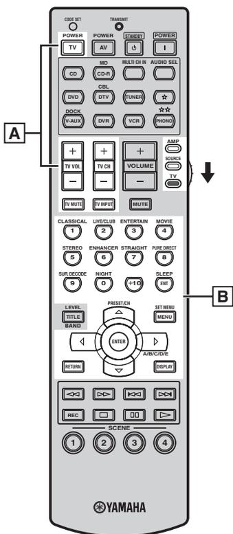
**A** 操作機器選択スイッチの位置にかかわらず、テレビを操作するときを使用します。
