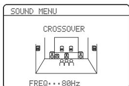
サブウーファーに出力する低音域成分の、周波数の上限を設定します。設定した周波数以下の低音成分が、サブウーファーまたはフロント左/右スピーカーに出力されます。
