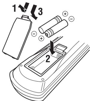
**1** リモコンの電池カバーのタブを押しながら、カバーをリモコンから取りはずす。
