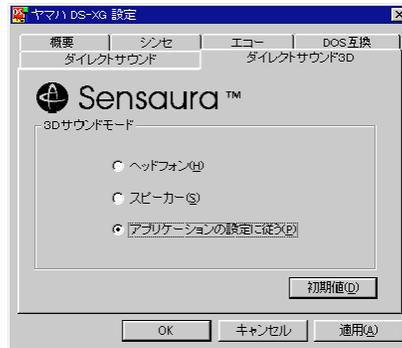
DS-XGは英国CRL社のSensaura技術に基づいた3Dサウンド(3Dポジショナルオーディオ)をサポートしています。ステレオスピーカーまたはヘッドフォンで全方位360度の定位感が得られます。一般的には、DirectSound3Dに対応したアプリケーションが、出力先としてステレオスピーカーまたはヘッドフォンを指定しますが、一部のアプリケーションでは出力先切り替えに対応していないため、強制切り替えモードを用意してあります。
