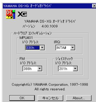
**NOTE** 上図のMPU401 I/Oアドレス、FM I/Oアドレス、ジョイスティックI/Oアドレスの設定が他のデバイスと競合している場合は、これらの設定を他の値に変更してください。
