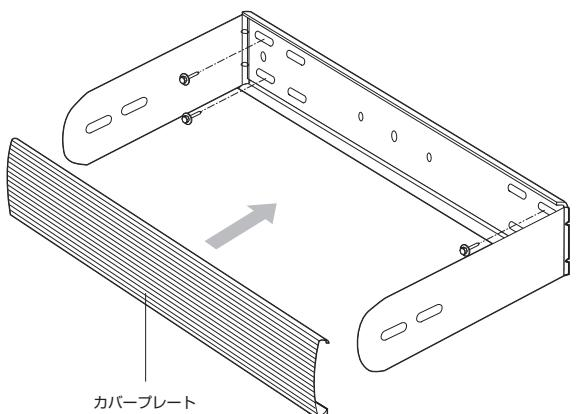
6. スピーカーU型マウント金具の間に置いて、付属の金具を取り付けます。
