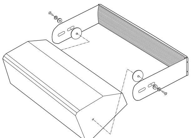
7. スピーカーの角度を調整したあと、留め具をしっかりと締め付けてスピーカーを固定します。
