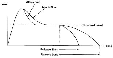
上の図のようにスレッショルドを超えた信号が、どのくらいの速さで圧縮されはじめるかを決めるのがATK(アタック)です。この値が小さい程すぐにコンプレッサーが効いて圧縮が始まります。ギターのカッティングや、シンセの立ち上がりの速いブラック系の音でパカーンとか、パコーンとかいう印象の音のバッキングを中心とした演奏がありますが、これらはこのアタックの値を小さくし、THR(スレッショルド)を-10~-15あたりに設定する事で近い感じになります。逆にアタックの値を大きくすると入力信号がスレッショルドを超えた瞬間ではなく、ワンテンポ遅れて圧縮が始まります。例えばサックスのやたらアタックのある鋭い音等は、逆にアタックの値を5.6~9程度の範囲に設定する事で、すぐにコンプレッサーでつぶされるという印象がなく、自然な音圧を得る事が出来ます。
