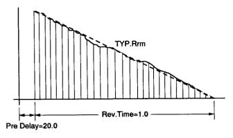
この図のように、〜線で示した所がリバーブ音が作られているディレイの音量だとします。それをコンプレッサーを使用する事で、---線のようなある程度ディレイの音量が揃った感じになるため、全体的にリバーブの音量が減衰中も揃ってきて最終的にリバーブ単体よりも更に抜けの良い効果になる訳です。
