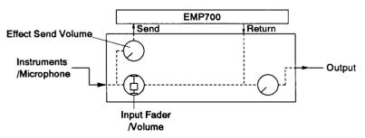
このセッティングは、EMP700 にプリセットされている Keyboard/Synth グループにある Preset No.44 (Pad Enhancer)、45 (Pad Reverb)、52 (Full Organ)、55 (Wide Piano) 等のステレオ感を更に強調するようなエフェクトや、67 (Slow Pan)、69 (Flanged Flange) のようなエフェクト音の方が主となるようなエフェクトの場合に最も効果的で、インプットフェーダー/ボリュームを "0" にしてエフェクトセンドレベルのみを上げて、まずエフェクトされた音を確認し、その後に
