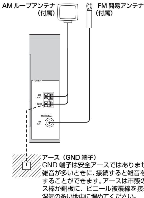
**2 AM ANT 端子と GND 端子のレバーを押し込んだ状態で、AM ループアンテナのコードを AM ANT 端子と GND 端子に差し込む。**
