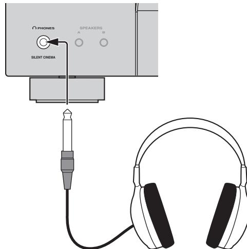
「サイレントシアター」モードでは、マルチスピーカーによる音場プログラムの効果を、ヘッドホンで擬似的に再現します。「サイレントシアター」モードで再生している間は、本体ディスプレイのSILENT CINEMAインジケーターが点灯します。
