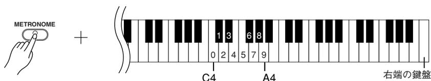
テンポを 1 ずつ上げたいときは、**[METRONOME]** を押したまま C#5 鍵盤を押します。テンポを 1 ずつ下げたいときは、**[METRONOME]** を押したまま B4 鍵盤を押します。
