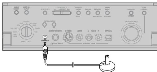
オプティマイザーマイクは実際に視聴する位置(リスニングポジション)に、耳と同じ高さで設置します。耳と同じ高さで設置する場合は、水平な台にのせるか、三脚を使います。
