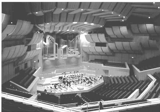
「その空間が持つ特有の音の響き」を音場と呼んでいます。コンサートホールなどで、私達は、楽器の音や歌手の声が直接聴こえてくる「直接音」のほかに、床や壁・天井などに一回反射してから聴こえてくる「初期反射音」、さらに何回も反射を繰り返しながら次第に減衰してゆく「後部残響音」を聴くことになります。建物内部の形状や広さ、それに内装材料の種類などによって、初期反射音や残響音の構成が異なり、そのホール特有の響きが生まれます。それが「音場」です。
