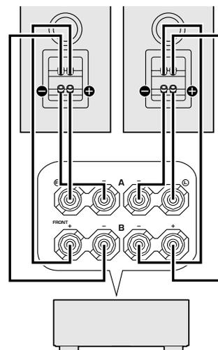
スピーカーのウーファー端子とツイーター端子を、それぞれFRONT A端子とFRONT B端子に接続します。
