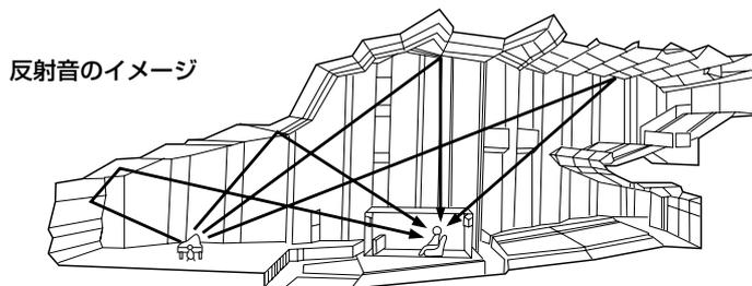
直接音、初期反射音、後部残響音がひとつになることで、リスナーは演奏会場や劇場をイメージすることができます。デジタル音場プロセッサはこの反射音、残響音を再現することで、音場を作り出します。
