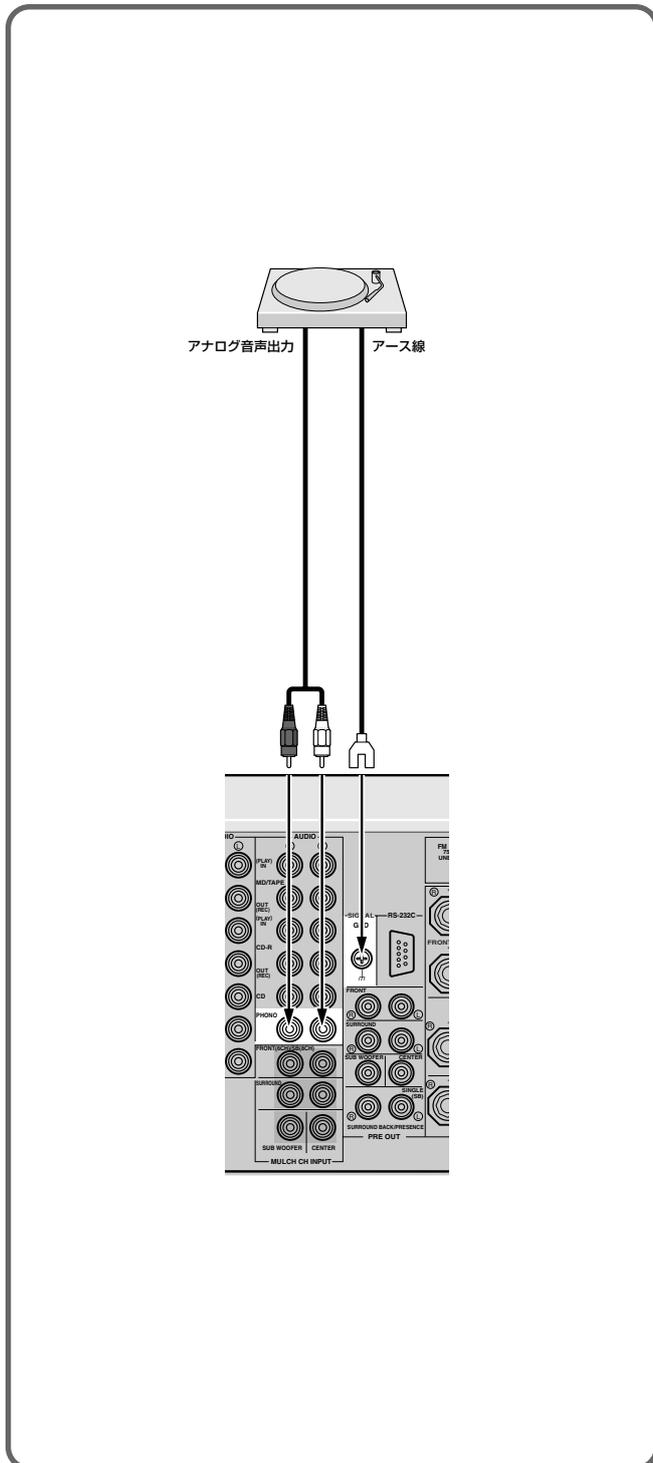
低出力型MCカートリッジ付のレコードプレーヤーを接続するときは、昇圧トランスまたはMCヘッドアンプを使って接続します。
