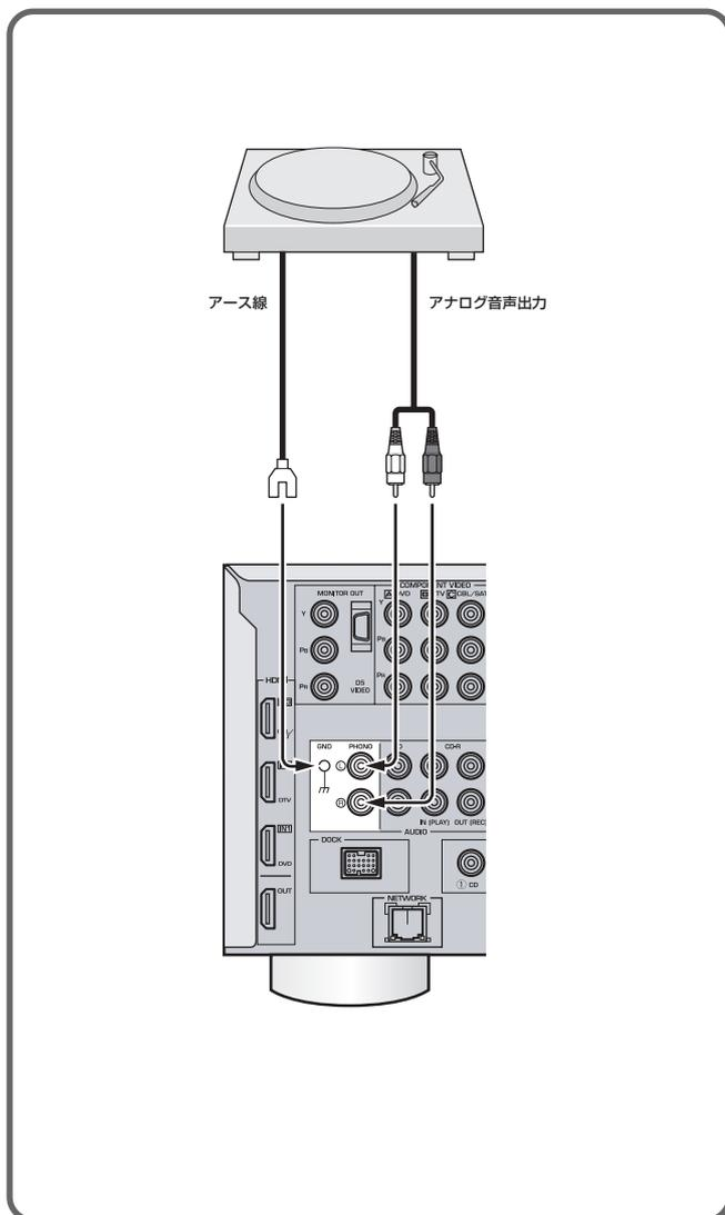
低出力型MCカートリッジ付のレコードプレーヤーを接続するときは、昇圧トランスまたはMCヘッドアンプを使って接続します。
