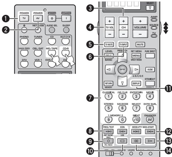
操作機器選択スイッチでSOURCEを選び、入力選択キーのMD/TAPEキーを押すとMDレコーダーを、CD-Rキーを押すとCDレコーダーを操作できます。
