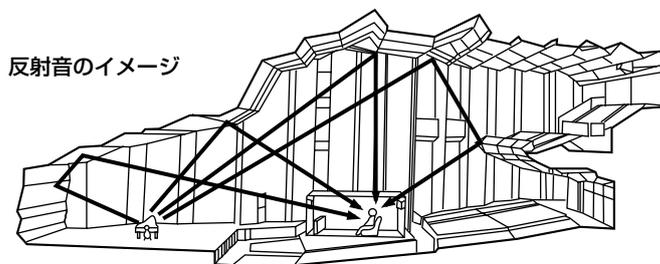
直接音、初期反射音、後部残響音がひとつになることで、リスナーは演奏会場や劇場をイメージすることができます。デジタル音場プロセッサはこの反射音、残響音を再現することで、音場を作り出します。
