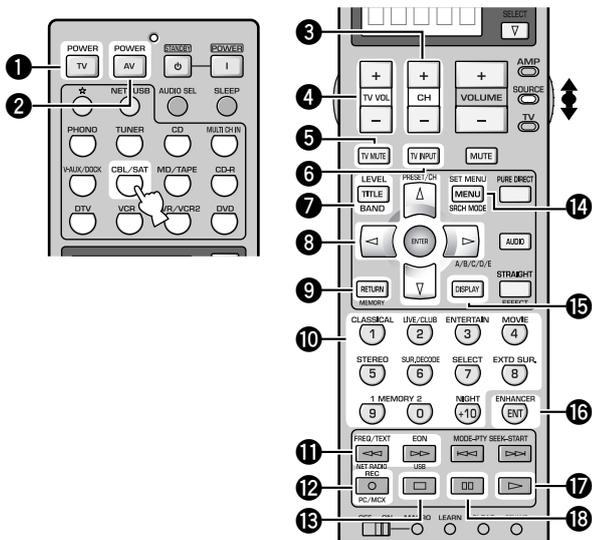
操作機器選択スイッチでSOURCEを選び、ライブラリー/リモコンコードを設定してから、入力選択キーのCBL/SATキーを押すと、衛星放送のチューナーを操作できます。
