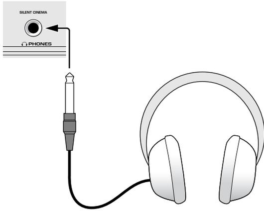
「サイレントシネマ」モードでは、マルチスピーカーによる音場プログラムの効果を、ヘッドホンで擬似的に再現します。「サイレントシネマ」モードで再生している間は、フロントパネルディスプレイのSILENT CINEMAインジケータが点灯します。
