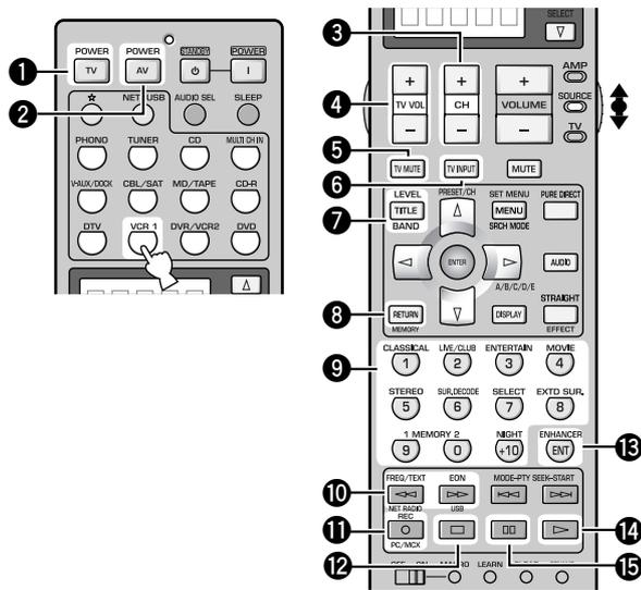
操作機器選択スイッチでSOURCEを選び、リモコンコードを設定してから、入力選択キーのVCR1キーを押すと、ビデオデッキを操作できます。
