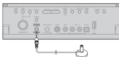
オプティマイザーマイクは実際に視聴する位置(リスニングポジション)に、耳と同じ高さで設置します。耳と同じ高さで設置する場合は、水平な台にのせるか、三脚を使います。三脚を使う場合は、三脚に付属のネジでオプティマイザーマイクを固定してください。
