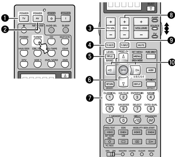
操作機器選択スイッチでSOURCEを選び、入力選択キーのTUNERキーを押すとチューナーを操作できます。
