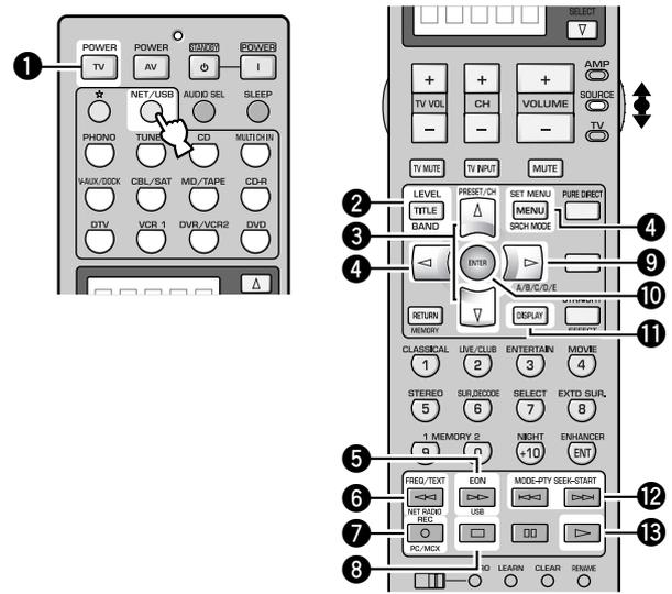
操作機器選択スイッチでSOURCEを選び、入力選択キーのNET/USBキーを押すと、ネットワークオーディオ/USBを操作できます。
