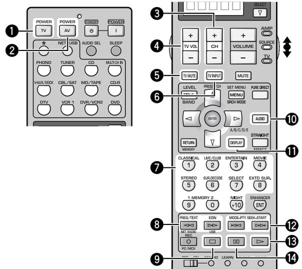
操作機器選択スイッチでSOURCEを選び、LDプレーヤーを接続した端子に対応するキーにライブラリー/リモコンコードを設定してから、そのキーを押すと、LDプレーヤーを操作できます。
