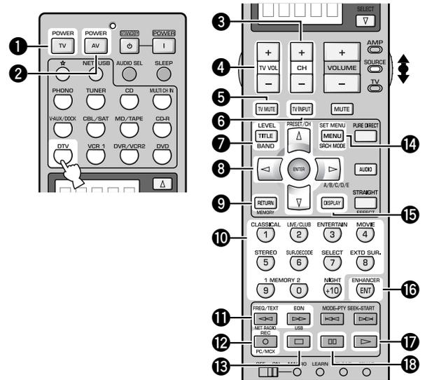
操作機器選択スイッチでSOURCEを選び、リモコンコードを設定してから、入力選択キーのDTVキーを押すと、テレビを操作できます。
