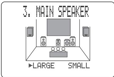
使用するメインスピーカーに合わせて、モード(LARGE/SMALL)を選択します。
