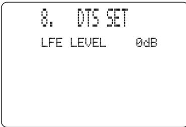
DTSでのLFE信号の再生レベルを設定します。
