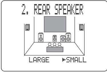
モニター画面には、リアスピーカーモードの状態がイラスト表示されます。LARGEのときリアスピーカーは大型になり、SMALLのときはリアスピーカーは小型になります。
