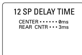
例えばフロント側のセンタースピーカーはL、Rスピーカーと同一線上に通常置きますが、本来ならば同時に出了音が同時にリスナーの耳に届くように、3つのスピーカーとリスナーの距離が同一になるのが理想的です。ディレイタイムを設定することによって、仮想的にセンタースピーカーとリアセンタースピーカーの位置を遠ざけ、リスナーと前後3つのスピーカーとの距離を合わせることができます。センターディレイは、音場の奥行き感やセリフの量感を増す効果があります。
