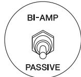
スピーカー使用中に、Bi-Amp/Passive切り替えスイッチを切り替えないでください。
