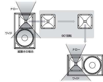
**NOTE** フロアモニターとして使用する場合は、下記の図のように上がWide (ワイド) 下がNarrow (ナロー) にホーンを設置してください。
