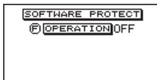
⑥エンコーダーを使って、プロテクトのON/OFFを切り換えます。
