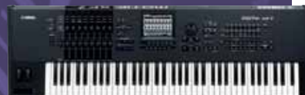
● MOTIF XF (2010年) 同時発音数:128 音色数[ノーマルボイス]プリセット:1,024、ユーザー:384、GM:128 [ドラムキット]プリセット:64、ユーザー:32、GM:1 波形メモリ:741MB相当(16ビットリニア換算)、 フラッシュメモリ・エクステンション・ボードにより最大2GBの拡張が可能
