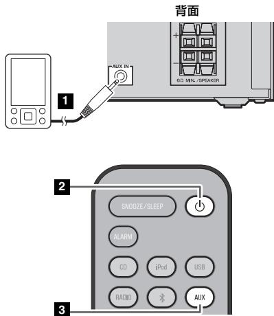
**1** 市販の 3.5 mm ミニプラグケーブルで本体背面の AUX 端子に外部機器を接続する。
