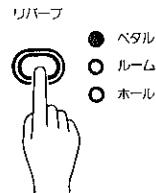
リバーブ切替ボタンを押して、希望する響きのランプを点灯させてください。
