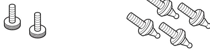
本製品を厚いじゅうたんなどの上に設置する場合、スパイクを取り付けることにより音質向上・ガタツキ防止が可能になります。「スパイク(②)を付けて本製品を使用する」を参照してください。
