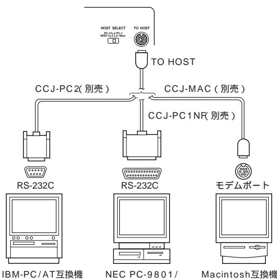
CVP-103 の【TO HOST】端子を使用する場合は、最初に、CVP-103 とコンピューターの電源を切った状態でケーブルを接続し、その後、コンピューター → CVP-103 の順番で、電源を入れてください。
