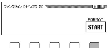
初期化中はLCD画面に横棒のグラフが表示され、経過を示します。完了すると、そのディスクに曲を録音したり、コピーしたり、その他のデータを保存することができるようになります。
