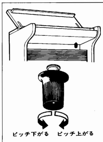
他の楽器と合奏するときに使います。合奏する楽器との音程が合っていないときのみ、このつまミで調整します。鍵盤下(棚板下)にあるつまミを右に回すと音程が上がり、左に回すと音程が下がります。つまミを回したとき手ごたえのある箇所が標準音程(440 Hz)になっています。
