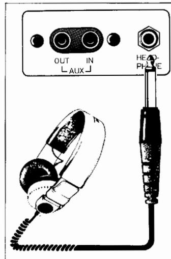
このジャックは鍵盤下(棚板下)にあります。スピーカー/ヘッドホン切換スイッチをヘッドホン側にし、ヘッドホンジャックに差し込んで使います。
