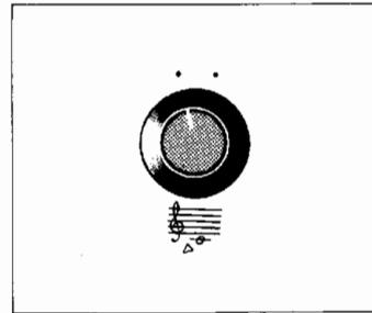
音域を中・低の2段に切り換えることができ、61鍵分の音域をすべてカバーします。つまみを回しますと、中央下の位置が音域表示ランプ⑤のついた位置に変わります。
