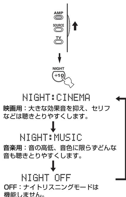
ナイトリスニングモードで再生している間は、フロントパネルディスプレイのNIGHTインジケータが点灯します。
