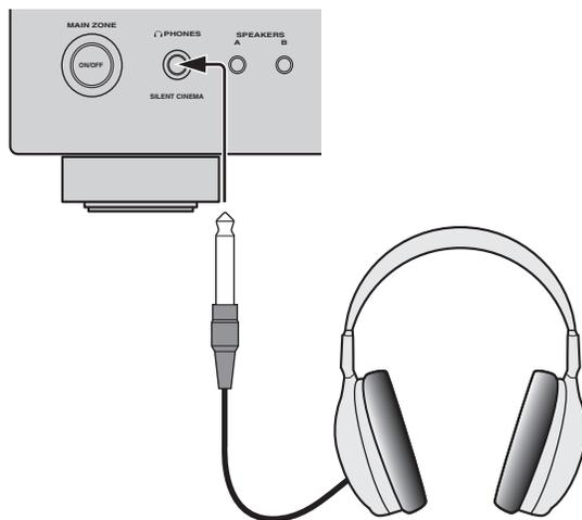
サイレントシネマモードでは、マルチスピーカーによる音場プログラムの効果を、ヘッドホンで擬似的に再現します。サイレントシネマモードで再生している間は、フロントパネルディスプレイのSILENT CINEMAインジケータが点灯します。
