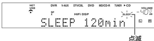
SLEEP インジケータが点灯になると、スリープタイマーの時間設定が完了し、ディスプレイは音場プログラム表示に戻ります。
