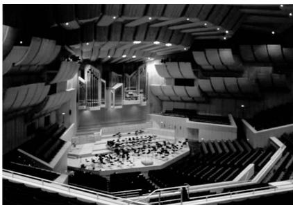
「その空間が持つ特有の音の響き」を音場と呼びます。コンサートホールなどで、私達は、楽器の音や歌手の声が直接聴こえてくる「直接音」のほかに、床や壁・天井などに1回反射してから聴こえてくる「初期反射音」、さらに何回も反射を繰り返しながら次第に減衰してゆく「後部残響音」を聴くことになります。建物内部の形状や広さ、それに内装材料の種類等によって、初期反射音や残響音の構成が異なり、そのホール特有の響きが生まれます。それが「音場」です。
