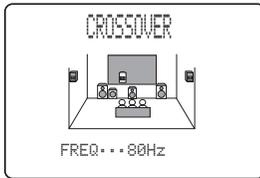
サブウーファーに出力する低音域成分の、周波数の上限を設定します。設定した周波数以下の低音成分が、サブウーファーまたはフロントL/Rスピーカーに出力されます。
