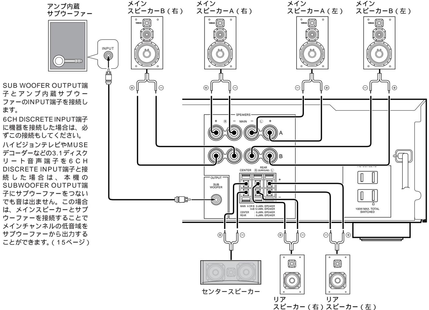
SUB WOOFER OUTPUT端子とアンプ内蔵サブウーファースのINPUT端子を接続します。
