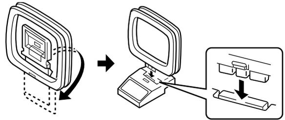
付属のAMループアンテナをAM ANT端子に接続します。
