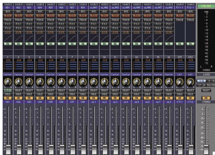
**■セレクト チャンネル (Selected Channel) ウィンドウ**では、各チャンネルのさらに詳細な情報が表示できます。
