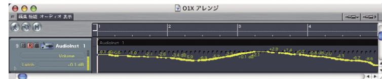
⑥ さらに、ES Mono の Cutoff のパラメータを操作して、音色の変化をチャンネルノブ 4 の Cutoff をコントロールしてレコーディングしてみましょう。
